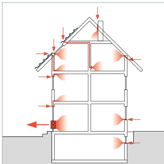
pro clima WINCON aspire l'air du bâtiment et l'évacue à l'extérieur. L'air s'engouffre de l'extérieur au niveau des défauts dans la couche d'étanchéité.
