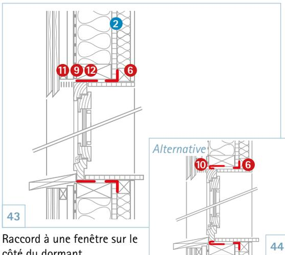
43 Raccord à une fenêtre sur le côté du dormant
